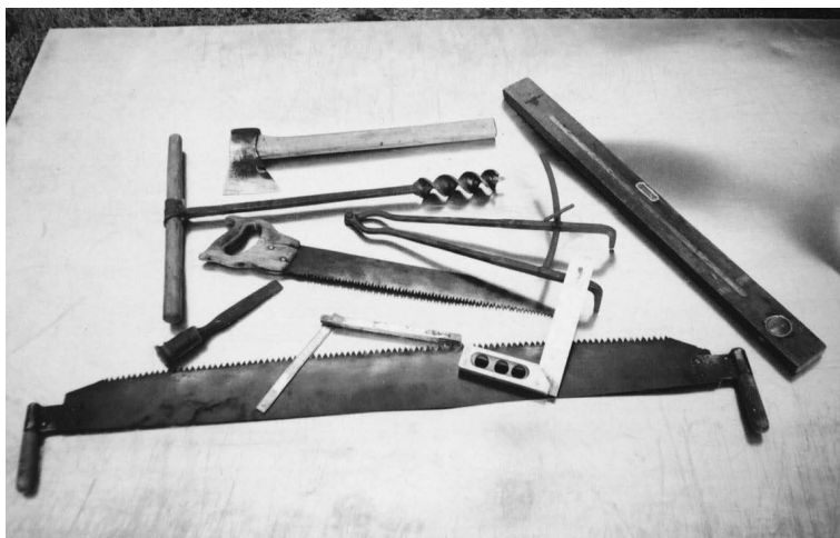
Dailidės naudoti įrankiai (iš viršaus): tašomasis kirvis, grąžtas, skečiamasis kampainis, vienarankis pjūklelis („fuskas“), pleištas („pleišas“), statieji kampainiai, dvirankis skerspjūklis („skerspiela“), gulsčiukas (dešinėje). 2001 m. Autorės nuotr.
